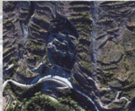
Fotografía aérea donde puede identificarse un deslizamiento en el entorno de este geolodía. La carretera discurre directamente sobre la masa deslizada de este deslizamiento complejo.
