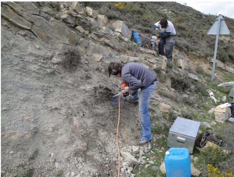
Foto: Extracción de muestras para estudios de anisotropía de la susceptibilidad magnética en la Cuenca de Cameros
