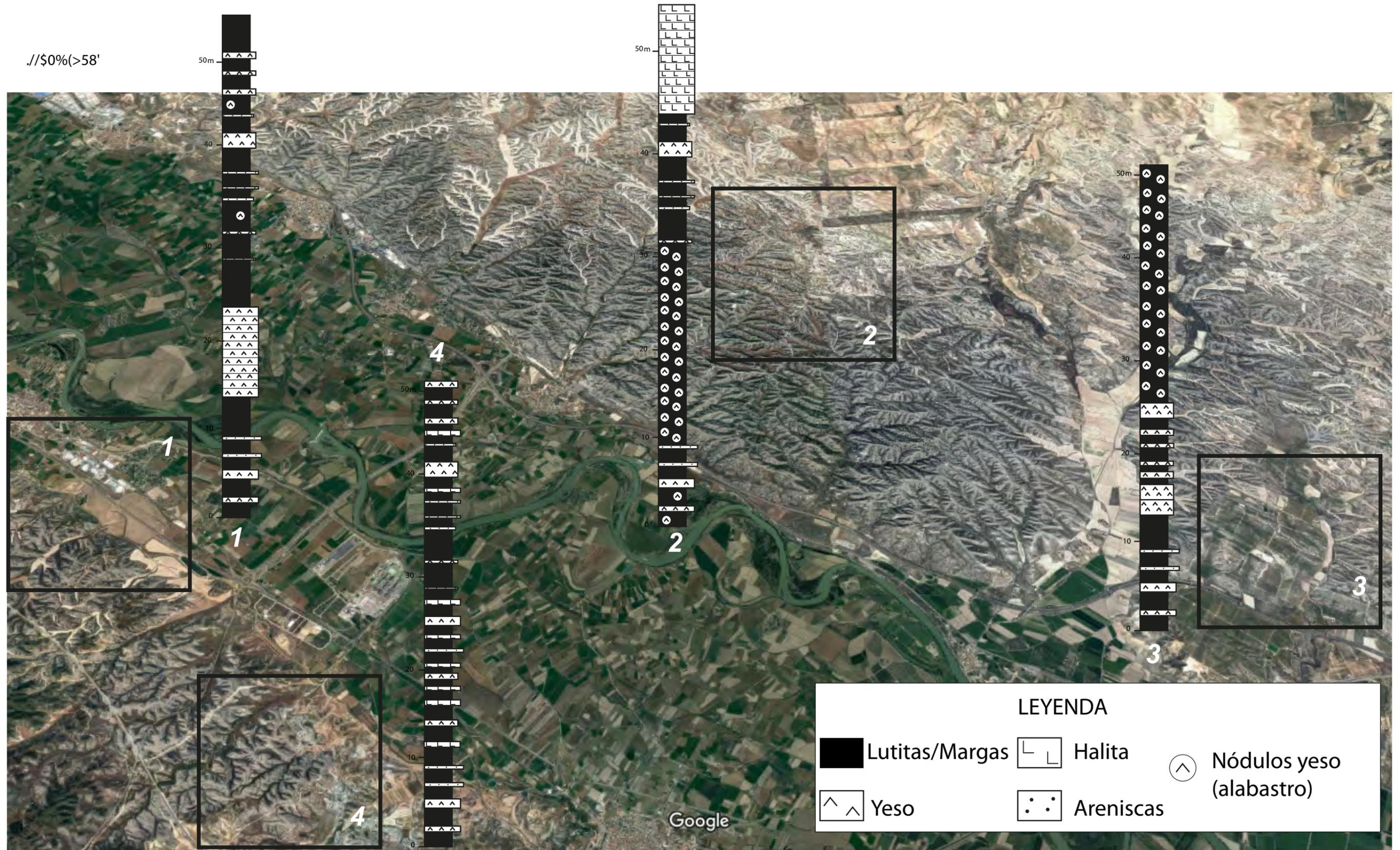
Figura 2: Mapa de Sector 2 (para las explotaciones de alabastro), marcando las cuatro cuadrículas mineras de investigación obtenidas por la empresa .
