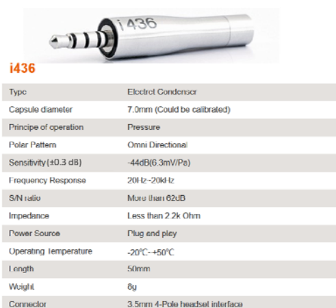
Figura 7. Transductor de medición de ruido.
