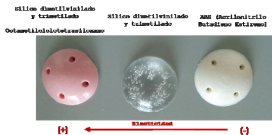
Figura 4. Diversos materiales intercambiables para el elemento actuador.
