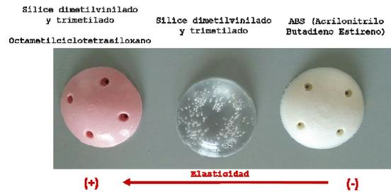
Figura 4. Diversos materiales intercambiables para el elemento actuador.
