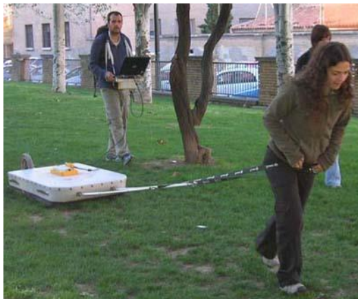
- Georradar (RAMAC Mălă Geosciences) con antenas de 500, 250, 100 y 50 MHz
