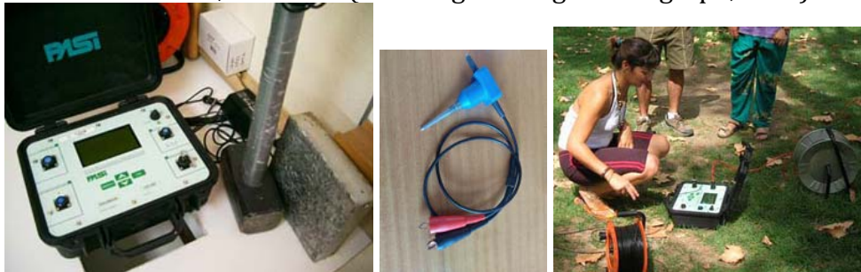
- Sísmica de maza, 3 canales (Civil Engineering Seismograph, PASI)
