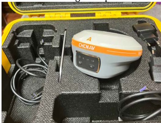
- Sistema Global de Navegación por Satélite - GNSS (Marca CHCNAV, Modelo i89)
