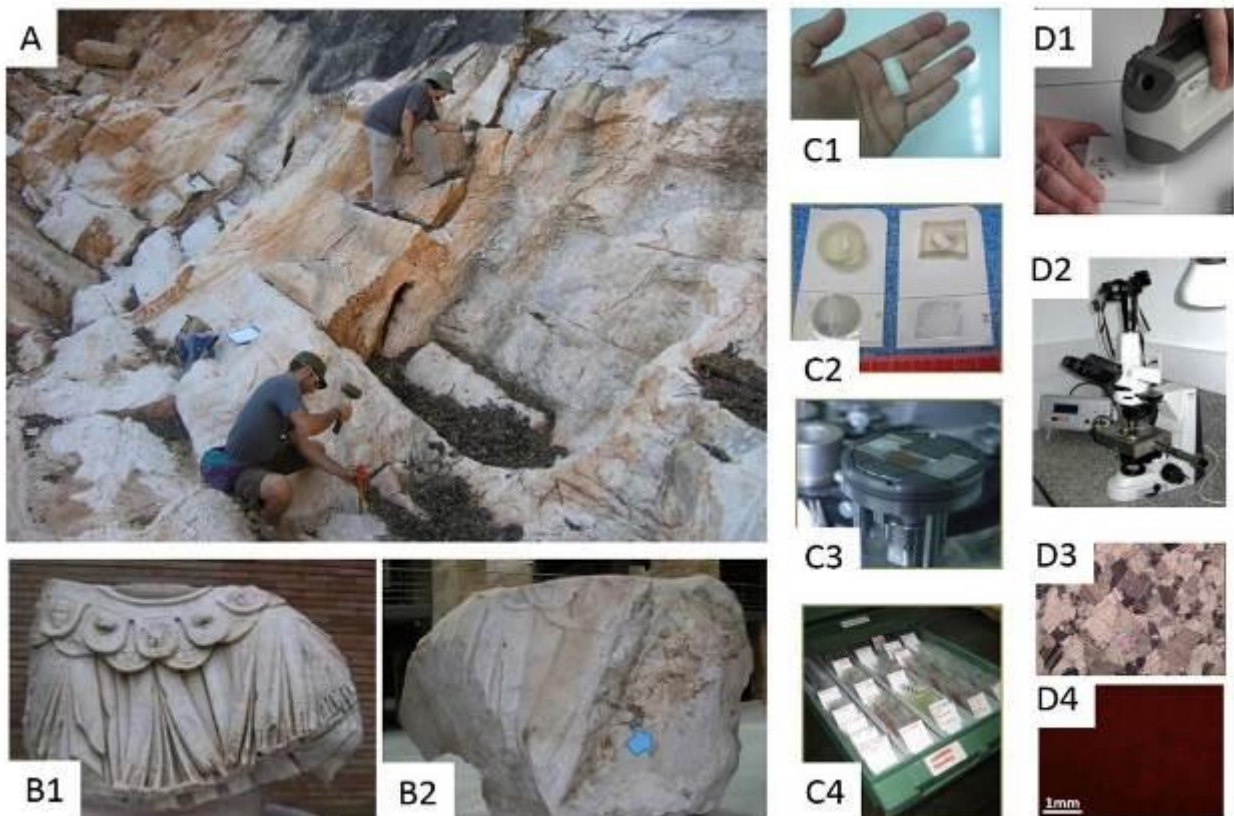
Línea de investigación de Arqueometría. A: Muestreo de mármoles en una cantera romana. B1-B2: pieza arqueológica del Museo Nacional de Arte Romano de Mérida (se señala con una flecha, la zona de muestreo en la parte no trabajada y no expuesta). C1-C4: Secuencia de elaboración de una lámina delgada a partir de una lasca tomada en la pieza arqueológica (C1), embutida en resina para su manipulación (C2), reducción de espesor hasta 30 micras (C3) y colección de láminas delgadas (C4). D1: Espectrofotómetro portátil para medición del color de los mármoles. D2: Equipo de catodoluminiscencia acoplado a un microscopio petrográfico. D3: Microfotografía del mármol en luz polarizada y analizada. D4: la misma imagen que la anterior, en catodoluminiscencia.
