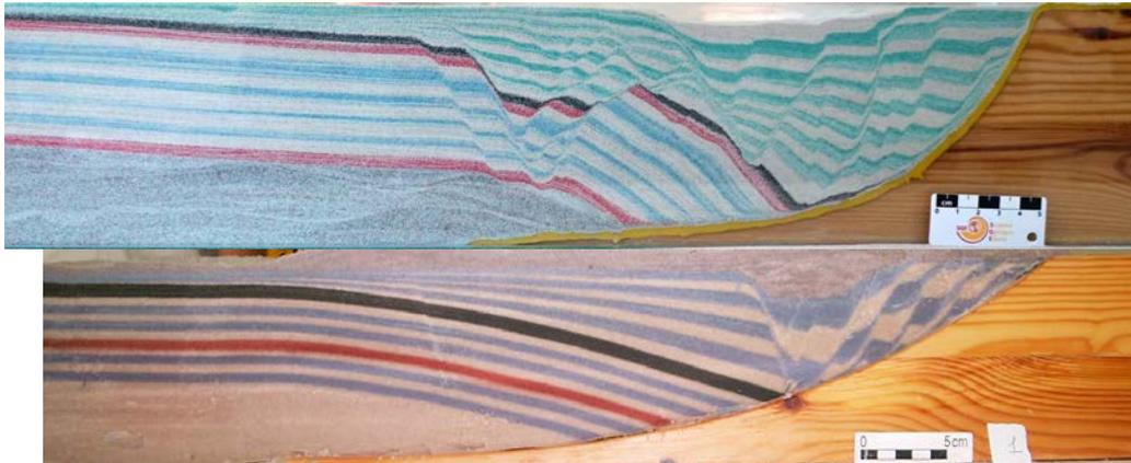
***Vista lateral de modelos analógicos de fallas lítricas con diferente curvatura***
