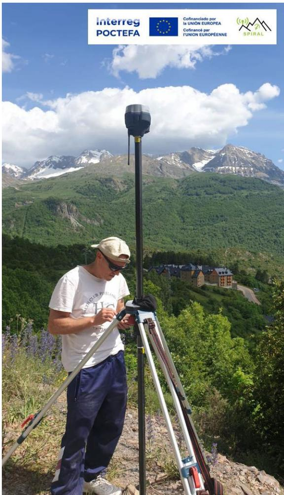
*Adquisición de coordenadas geográficas de una base topográfica en el deslizamiento de Argualas (Pirineo Central)*
