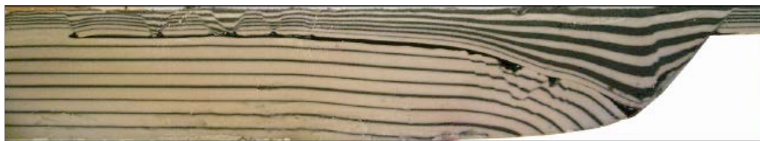
Falla lítrica con nivel de despegue intercalado
